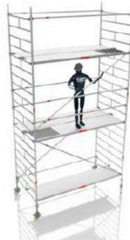
5.6 Steigen Sie über die Innenseite der Standleiter 10 durch die Durchstiegsöffnung 7 und setzen Sie sich auf den Belag. Montieren Sie nun sitzend die Rückengeländer 1 an den zweiten Sprossen über dem Belag.
