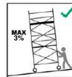
Die maximale Neigung für das Verfahren auf ausreichend tragfähigem Untergrund beträgt 3% und ist über Eck oder in Längsrichtung erlaubt. Nach dem Verfahren müssen alle Lenkrollen mit Hilfe des Bremshebels arretiert werden. Die Schrittgeschwindigkeit darf nicht überschritten werden.
