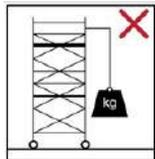
Es dürfen keine schweren Objekte und Materialien mit Hilfe von Hebezeugen von der Fahrbaren Arbeitsbühne aus angehoben werden.
