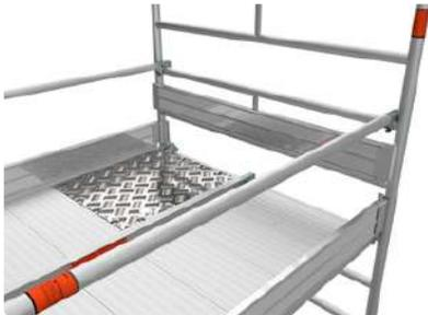
6.1 Längsbordbretter 5 werden gegenüberliegend in der Gerüstinnenseite auf den Belag aufgestellt. Anschließend schieben Sie die Stirnbordbretter 4 stirnseitig zwischen die Längsbordbretter 5.
