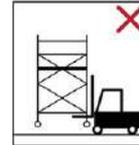
Die Fahrbare Arbeitsbühne darf nicht mit einem Kran, Stapler oder ähnliches angehoben und versetzt werden.
