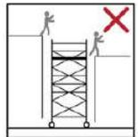
Das Übersteigen zwischen der Fahrbaren Arbeitsbühne und anderen Objekten oder Bauwerken sowie das Springen auf der Arbeitsplattform ist nicht erlaubt.
