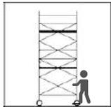
Nach dem Verfahren der fahrbaren Arbeitsbühne, sind die Lenkrollen durch Niederdrücken des Bremshebels zu arretieren.
