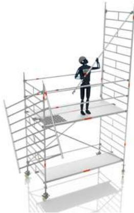
5.1 Die erste Standleiter 10 aufstecken und mit Federstecker sichern wie in Punkt 4.6. Hängen Sie jetzt zwei Rückengeländer 1 in die oberste Sprosse der bereits montierten Standleiter 10. Die zweite Standleiter hängt bereits auf der gegenüberliegenden Seite am Rohrverbinder der ebenfalls montierten Standleiter.
